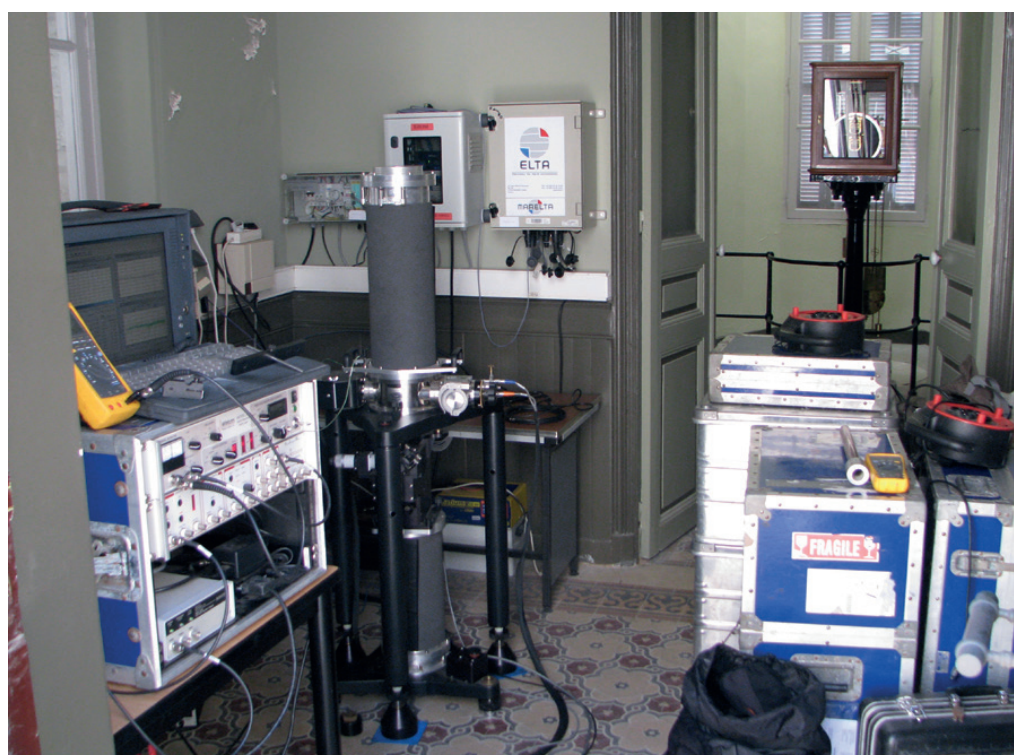
Figure 3. Mesures de gravimétrie absolue avec un FG5 au marégraphe de Marseille.
