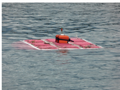
Figure 4. Différents systèmes de mesure du niveau marin par bouées GNSS.
