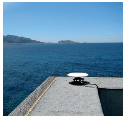
Figure 3. L'antenne de la station GNSS du marégraphe de Marseille.
