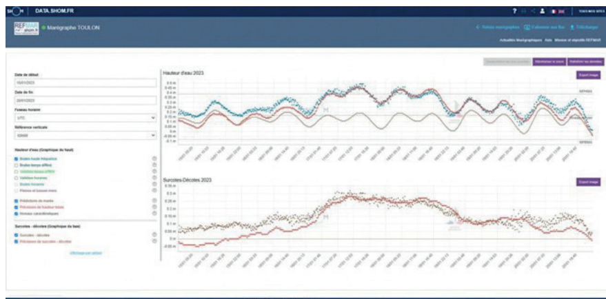
Figure 5. Séries temporelles haute fréquence des prévisions et des observations au marégraphe de Toulon. En haut sont représentées la hauteur moyenne sans effet atmosphérique (marée, en marron), les prévisions de la hauteur d'eau totale hauteur d'eau à 00H UTC pour les 24 heures à suivre (rouge) et les observations de la hauteur d'eau totale (bleu) mesurées par le marégraphe. En bas sont représentées les prévisions de surcote à 00H UTC pour les 24 heures à suivre (rouge) et les surcotes calculées par différence des courbes des hauteurs d'eau totale observées et de la hauteur de la marée locale.
