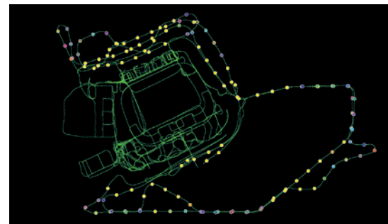
Figure 14. Contraintes absolues intégrées lors d'un relevé SLAM dans la compensation globale : les contraintes absolues sont des points GNSS-PPK. Chaque pastille de couleur représente une contrainte en position.
