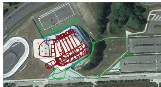
Figure 16. Aperçu des trajectoires pour réaliser le scan massif d'un site : les trajectoires vertes sont celles avec contraintes absolues, les trajectoires bleues permettent de rattacher l'intérieur et l'extérieur, les trajectoires rouges sont toutes les trajectoires intérieures.
