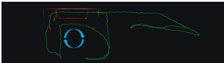
Figure 7. La fermeture de boucle en SLAM-LiDAR pour réduire le taux de dérive.
