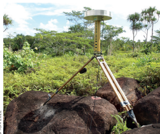
Photo 5. Antenne Leica AT504 équipée d'un cylindre à code-barre.
