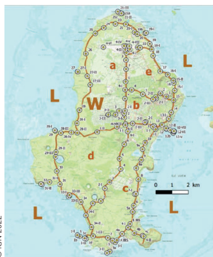
Figure 3. Wallis : réseaux de nivellement 2022.
