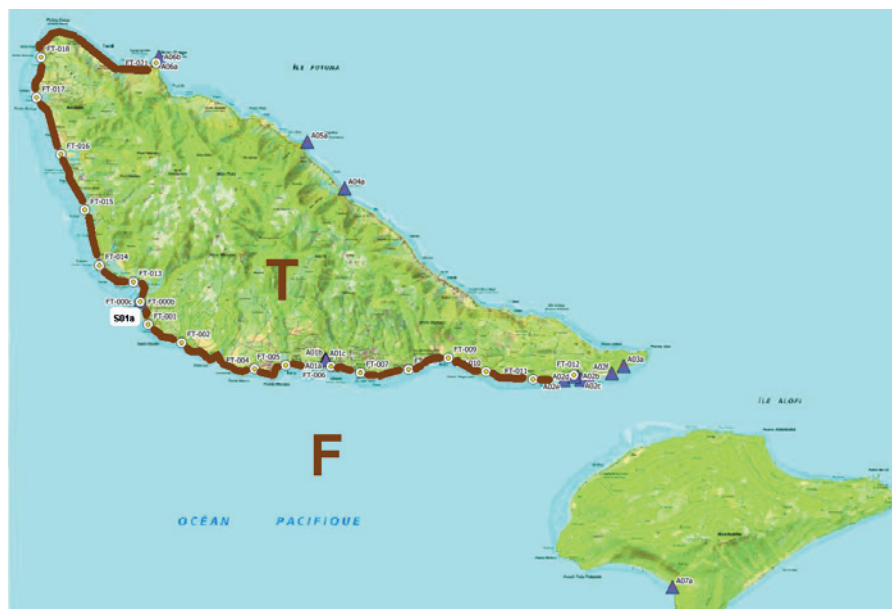
Figure 2. Réseaux de géodésie et nivellement 1996 à Wallis et Futuna (DITT).
