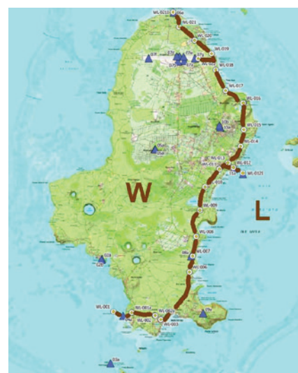
Figure 2. Réseaux de géodésie et nivellement 1996 à Wallis et Futuna (DITT).
