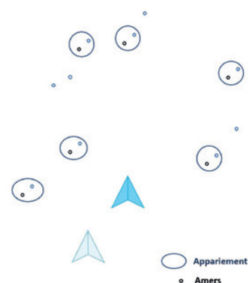
Figure 3. Étape 3 appariement des amers par couple (algorithme ICP).
