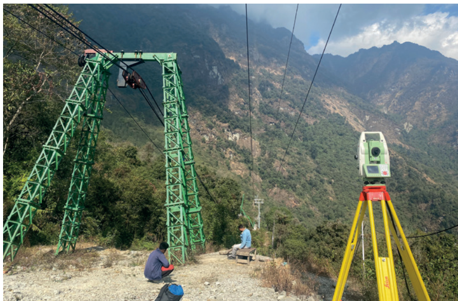
Figure 2. Le blondin, en vert, la ligne de la télécabine Bhaleydhunga et la station totale.
