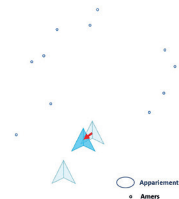
Figure 4. Étape 4 calcul de l'erreur de position en déterminant la transformation inverse issue de l'ICP. La carte dispose désormais de nouveaux amers.
