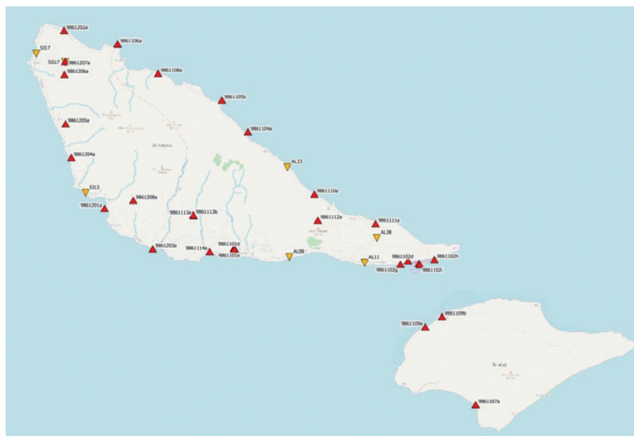
Figure 6. Futuna, les 38 stations GNSS : 31 points géodésiques observés en 2022 en rouge et 7 stations nivelées et mesurées en GNSS sans matérialisation en jaune.
