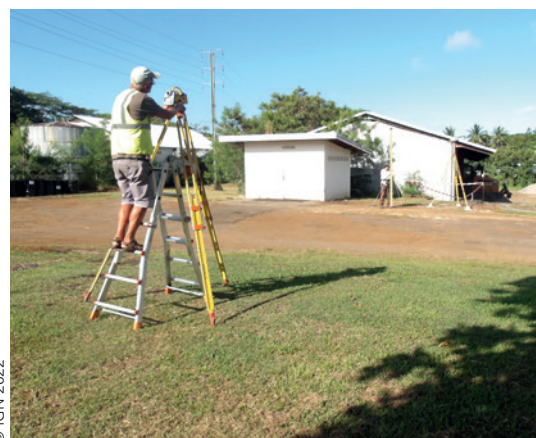
Photo 6. Nivellement d'un point géodésique.
