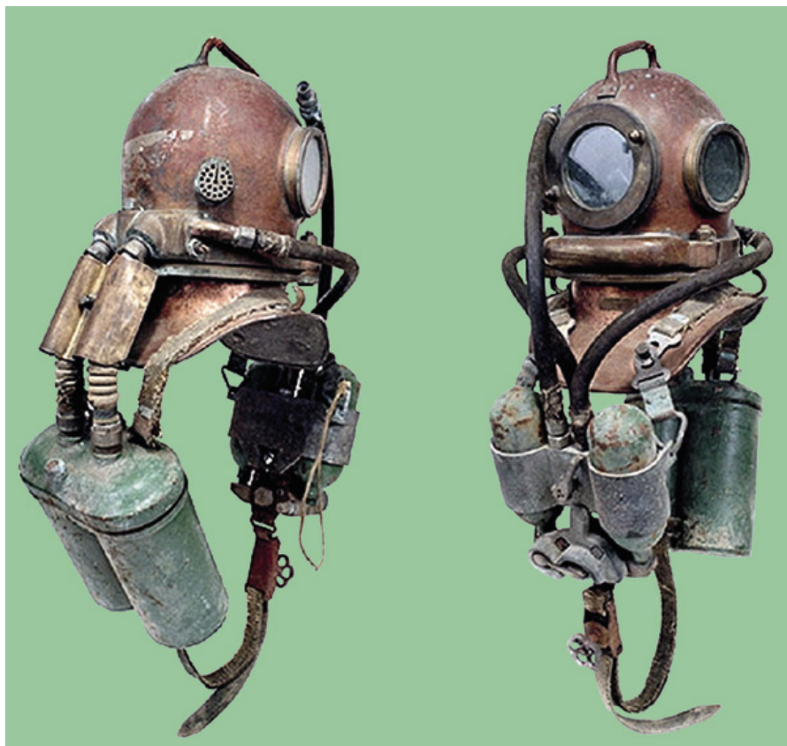
Figure 18. Un recycleur russe d'entre les deux guerres.
