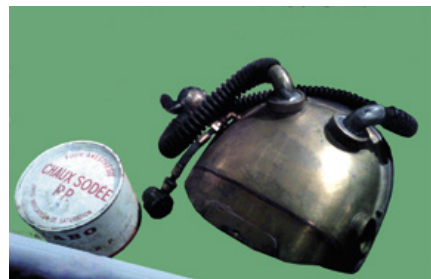
Figure 17. Un vieux recycleur et sa boîte de soud e!
