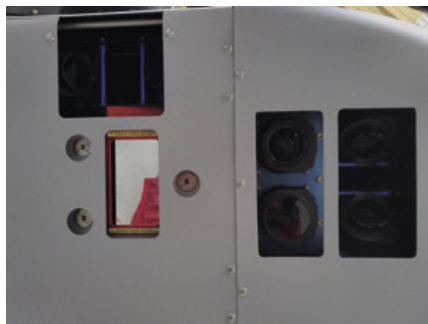
Figure 4. Vue des optiques LiDAR et caméras sous la nacelle de mesure.
