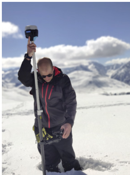
Figure 1. Un géomètre utilise le GNSS pour obtenir des coordonnées dans un système géodésique donné avec une précision centimétrique.
