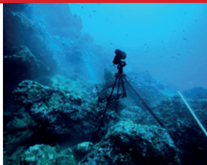
Figure 15. Numérisation 3D subaquatique de l'entrée de la grotte Cosquer, à -37 m.
