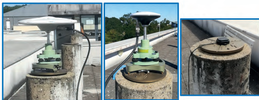
Figure 8. Les différentes antennes utilisées lors des tests : Trimble Zephyr 2 (à gauche), ArduSimple AS-ANT2B-CAL-L1L2-15SMA-00 (au milieu) et u-blox ANN-MB-00-00 (à droite).
