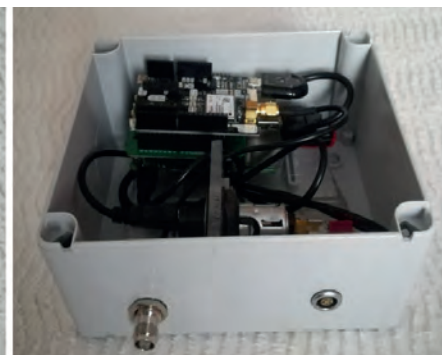
Figure 5. Prototype de récepteur GNSS bas coût dédié au levé en mode statique rapide.
