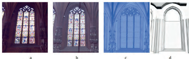
Figure 6. Exemple de modélisation géométrique : a) photographie ; b) nuage de points colorisé ; c) modèle maillé surfacique ; d) modèle basé sur des primitives géométriques (Landes et al., 2015).
