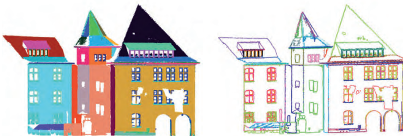
Figure 4. Segmentation de façades en plans principaux (à gauche) et détection des points de contours (à droite), (Boulaassal et al., 2009).
