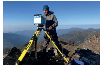
Figure 4. Mesure gravimétrique.
