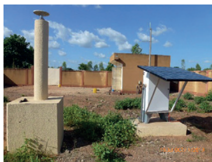
Figure 8. Station GNSS du réseau BF-CORS.
