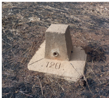
Figure 2. Repère de nivellement du NGAO1958 dans le Sud-Ouest.
