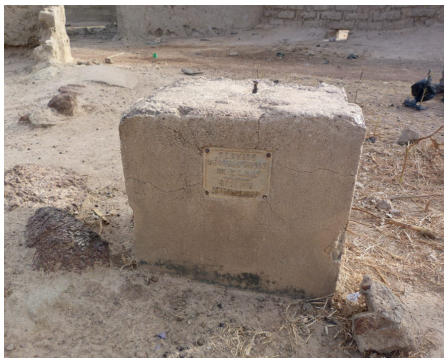
Figure 1. Station astronomique installée par le Service géographique de l'AOF dans la commune rurale de Tita, région du Centre-Ouest.
