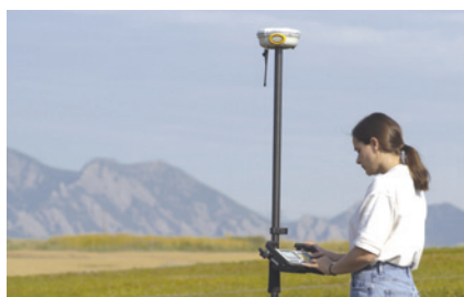
2003 : système GPS Trimble 5800 - Poids : 1,21 kg - Capacité mémoire : > 3000h de données (LI/L2) Consommation électrique : < 2,5 W - Câbles : aucun - Technique de lever : RTK pour des positions instantanées de précision centimétrique (post-traitement disponible)
