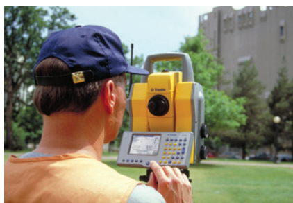
2003 : Trimble DR300+ - Durée de la mesure : 3 secondes - Résultats : instantanés - Mesure sans réflecteur jusqu'à plus de 300 m
