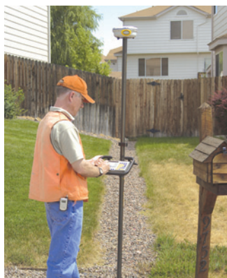
Figure 7 : un mobile sans câble doté de plusieurs connexions Bluetooth : le récepteur GPS Trimble 5800, l'enregistreur de données Trimble ACU et le téléphone cellulaire.
