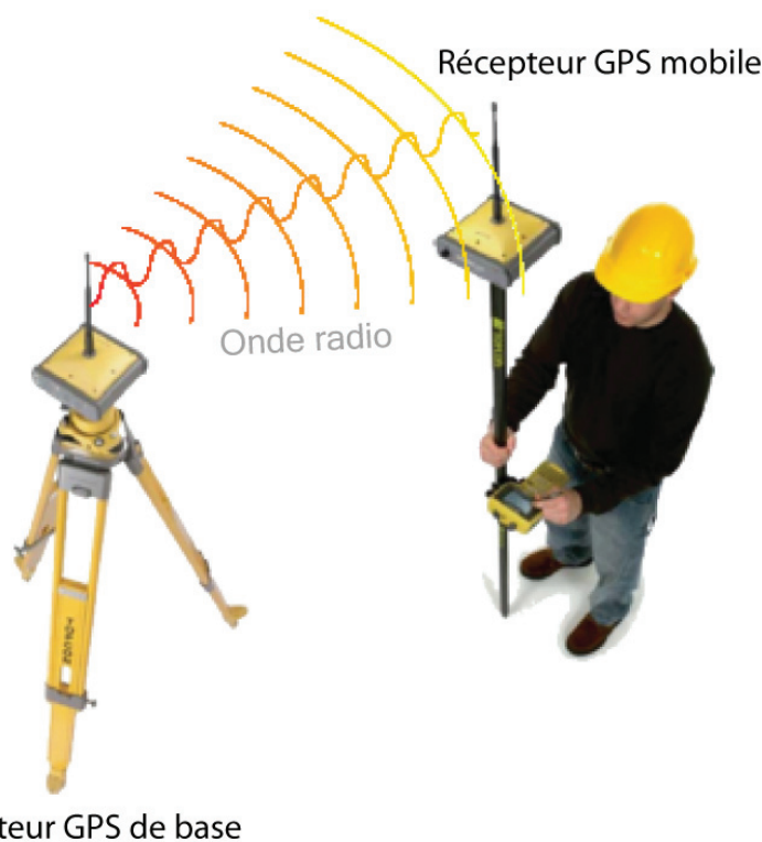
Figure 1 : liaison radio au service de GPS-RTK
