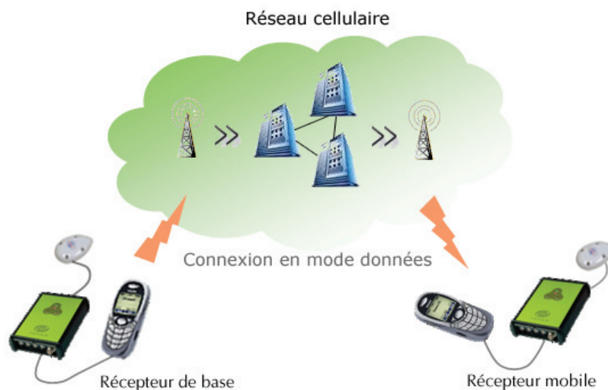
Figure 2 : diffusion de corrections GPS via GSM
