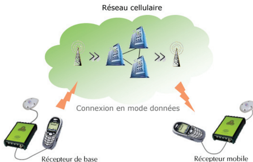
Figure 2 : diffusion de corrections GPS via GSM
