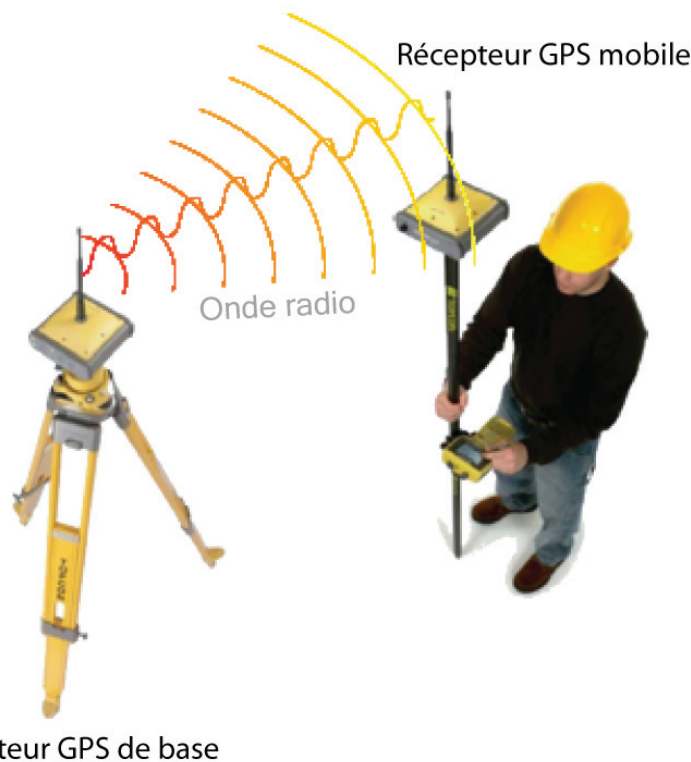
Figure 1 : liaison radio au service de GPS-RTK
