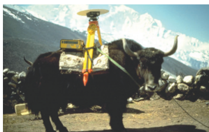
Années 1990 : système GPS Trimble 4000SST Poids : plus de 20 kg (yak exclu !) - Capacité mémoire : 6h de données (LI/L2) Consommation électrique : 10 W - Câbles : nombreux - Technique de lever : post-traitement seul
