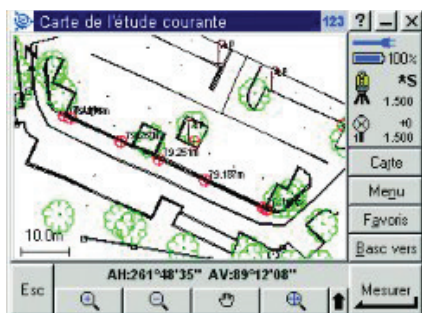
Figure 5 : des unités de saisie de données dotées d'écrans tactiles en couleurs de grande dimension permettent l'exécution de logiciels de saisie de données basés sur la carte.
