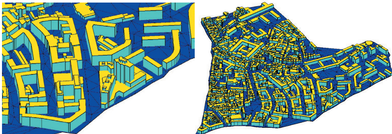
Figure 1 : Extrait de restitution d'un quartier de Strasbourg (Krutenu) pour la constitution d'un modèle de rugosité.
