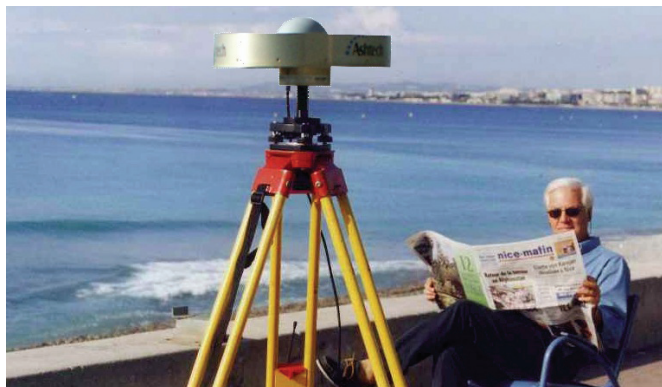
Figure 5 : Observation d'un point géodésique situé sur la Promenade des Anglais - Matériel utilisé : Antenne ASHTECH 701945E_M, Récepteur THALES 6502
