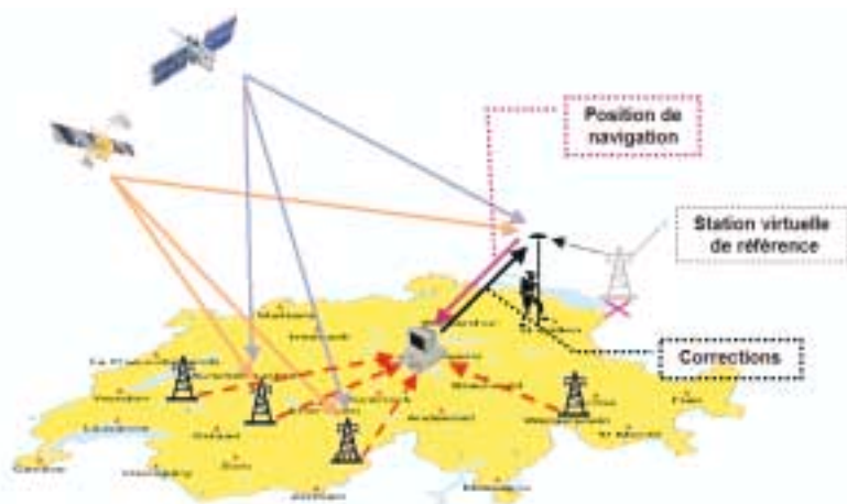
Figure 3 : Principe de la station virtuelle de référence
