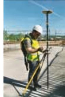
> Un réseau de type VRS (stations virtuelles de référence) GPS + GLONASS révolutionne la prise de mesures par satellites sur le terrain
