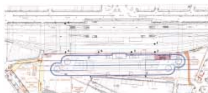
Figure 2 : Positionnement des capteurs HLS sur le viaduc
