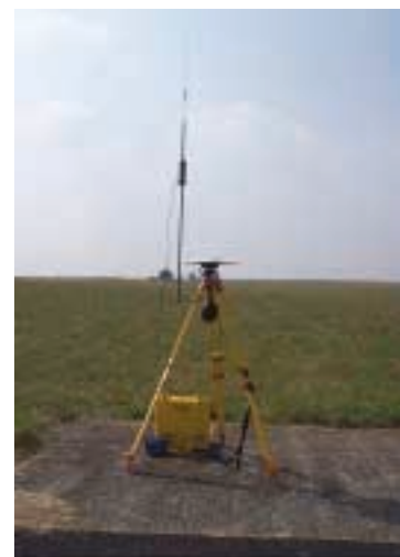
Figure 3 - Référence GPS en station sur un point du réseau d'appui
