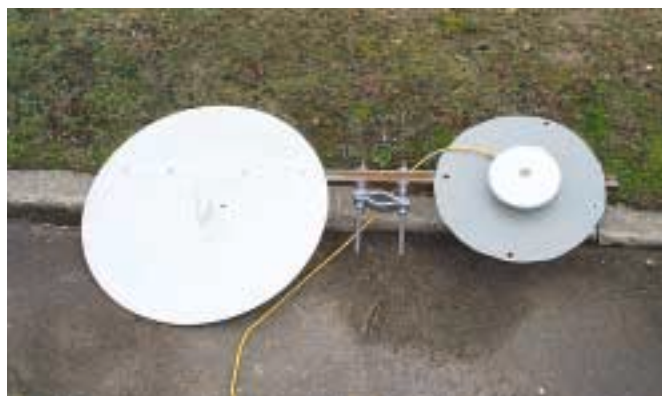
Figure 5 - Montage du transpondeur et de l'antenne GPS
