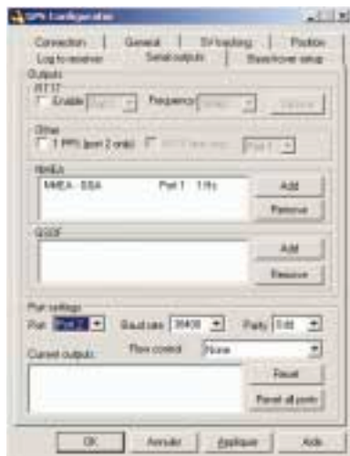
Figure 7 - Paramétrage d'une sortie NMEA sur un récepteur GPS Trimble
