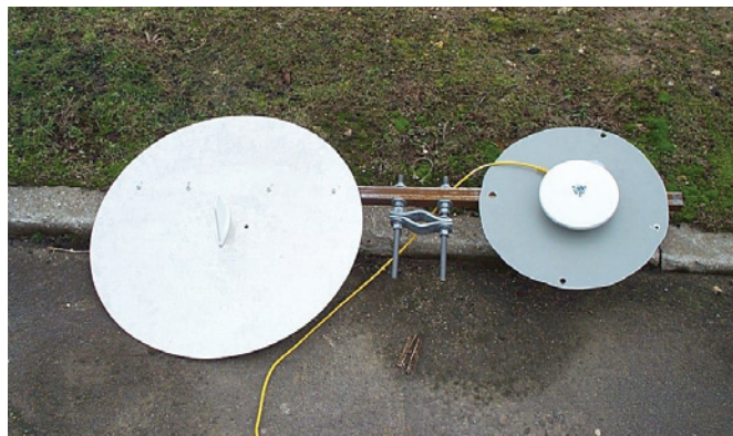
Figure 5 - Montage du transpondeur et de l'antenne GPS
