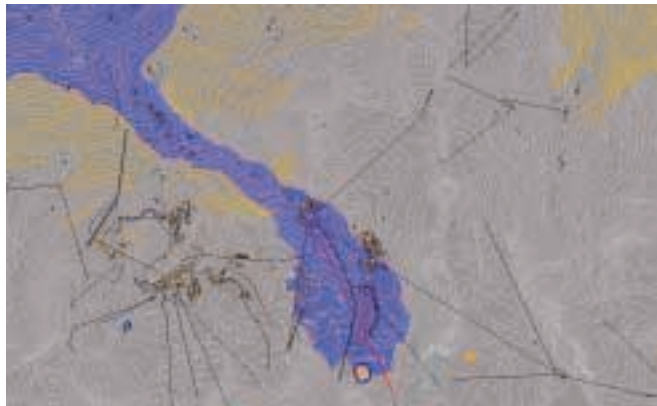
Analyse raster/écoulement potentiel de l'eau à partir d'une réserve colinaire (il s'agit de réserves d'eau conçues spécialement pour accumuler de l'eau en altitude afin de l'utiliser dans le système de neige de culture. Elle circule donc par gravité)
