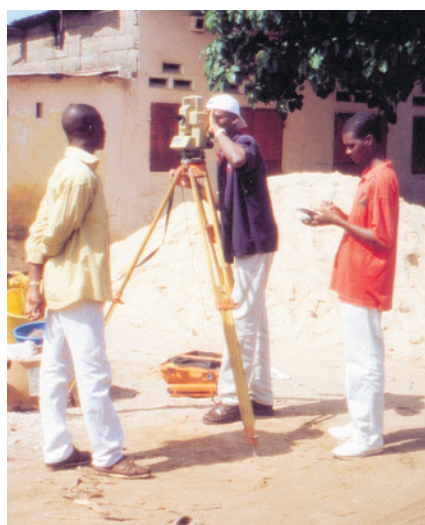
Polygonale de précision autour de l'école, exécuté avec la méthode des trois trépieds
