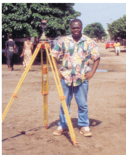
Polygonale de précision autour de l'école, exécuté avec la méthode des trois trépieds
