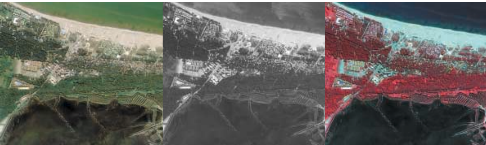
Fig. 1 : Côte Adriatique, Italie. Images couleur, panchromatique nadir et fausse couleur. H=1500 m s/sol, GSD=15cm. Images totales 12K x 70K, 18.9 km 2 ; extraits 12K x 14 K, 3.8 km 2 .
