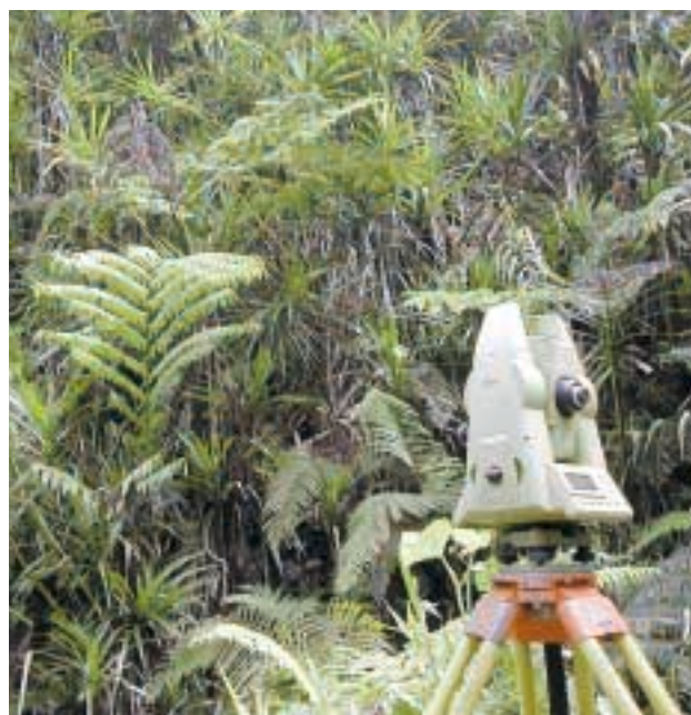
Figure 2 : Tachéomètre en station dans un environnement difficile
