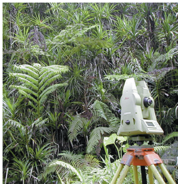
Figure 2 : Tachéomètre en station dans un environnement difficile
