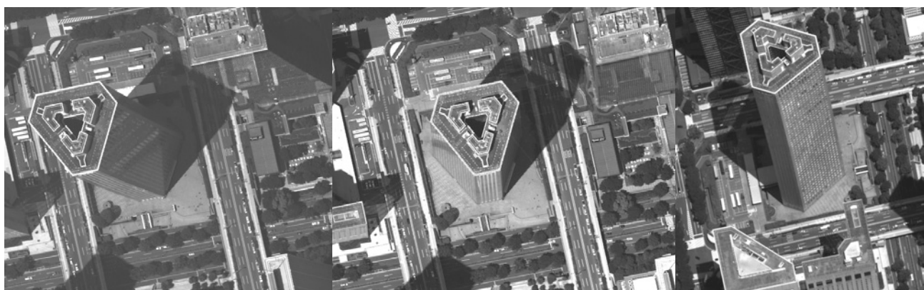
Fig. 4 : Shinjuka, Tokyo, Japon. Images panchromatiques arrière, nadir et avant. H=2000 m s/sol, GSD=20cm. Images totales 12K x 53K, 25.4 km² ; extraits 1120 x 1320, 5.9 ha
