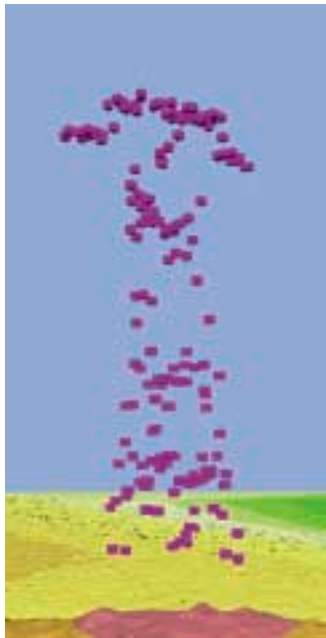
Fig. 3 : points d'un pylône obtenus par altimétrie laser
