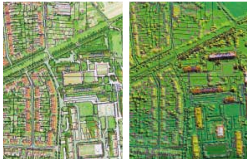
Fig. 5 : orthophotographie (à gauche) et MNS issu de données laser (à droite) avec superposition de données vectorielles
