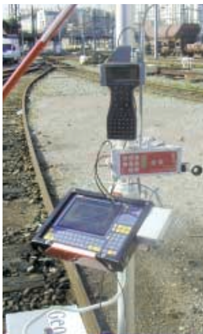
Fig. 4 : Adaptation du distancemètre
