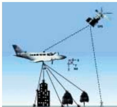
Figure 1 : Schéma d'un dispositif d'altimétrie par laser aéroporté
