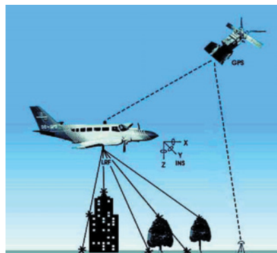
Figure 1 : Schéma d'un dispositif d'altimétrie par laser aéroporté
