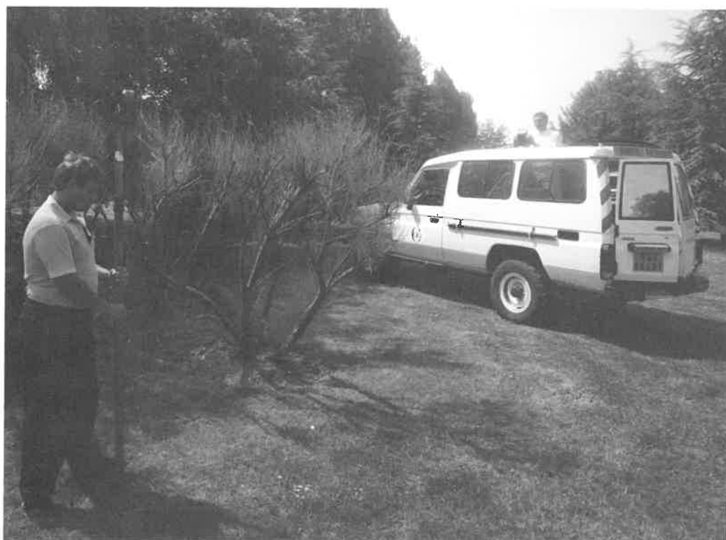
Implantation/levé en visées rayonnées à partir de la station inertielle
