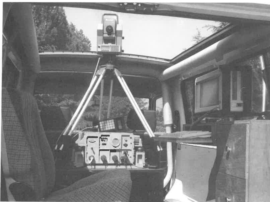
Système GEODINE 30 - Tachéomètre électronique en position haute
