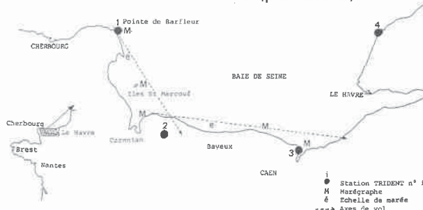
PLANCHE 2. — Mission "Baie de Seine". Schéma des axes de vol. Situation des stations TRIDENT, des marégraphes et des échelles de marée.
