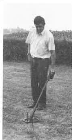
Détermination de verticalité d'un point avec émetteur- récepteur 2B SENSOR.
