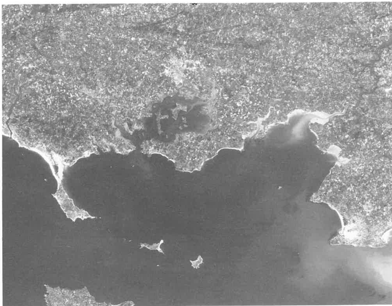
Fig. 3d : niveau 2, aux corrections de système viennent s'ajouter la prise de points d'appui mesurés sur une carte fournie par l'utilisateur ou à défaut de documents cartographiques utilisables par la réalisation de points GPS sur le terrain.
