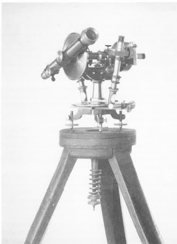
Theodolite "Bamberg" (Collection ENSAIS).
