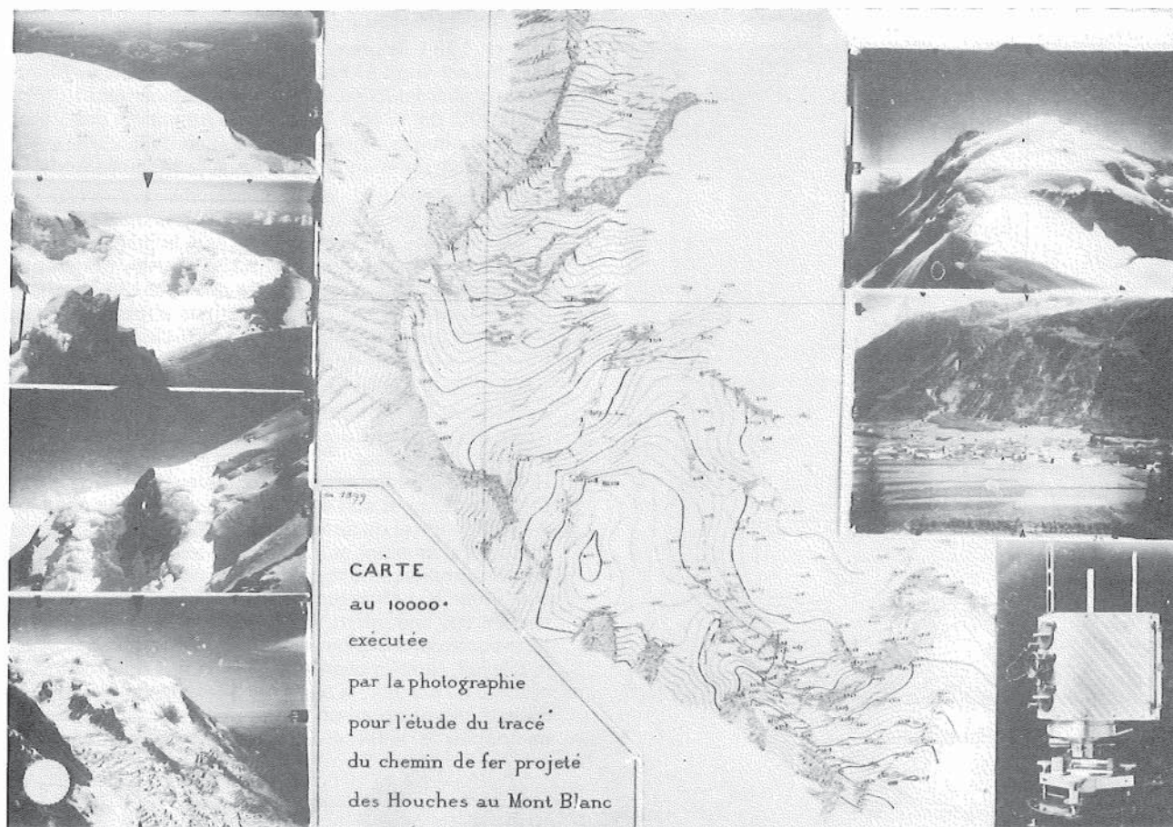
Fig. 5. Autour d'une carte réalisée pour l'étude du tracé du chemin de fer les Houches — Mont-Blanc, le phototachéomètre et les photographies utilisées pour la carte.
