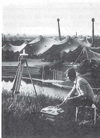
De jour comme de nuit, le système Wild-Magnavox WM 101 détermine avec précision les coordonnées x, y, z, de points sans intervisibilité. La photographie a été prise au stade Olympique de Munich.
