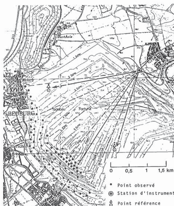
Fig. 1 : Observation des gradins de mine à ciel ouvert par mesure de distances (Nehring 1983).
