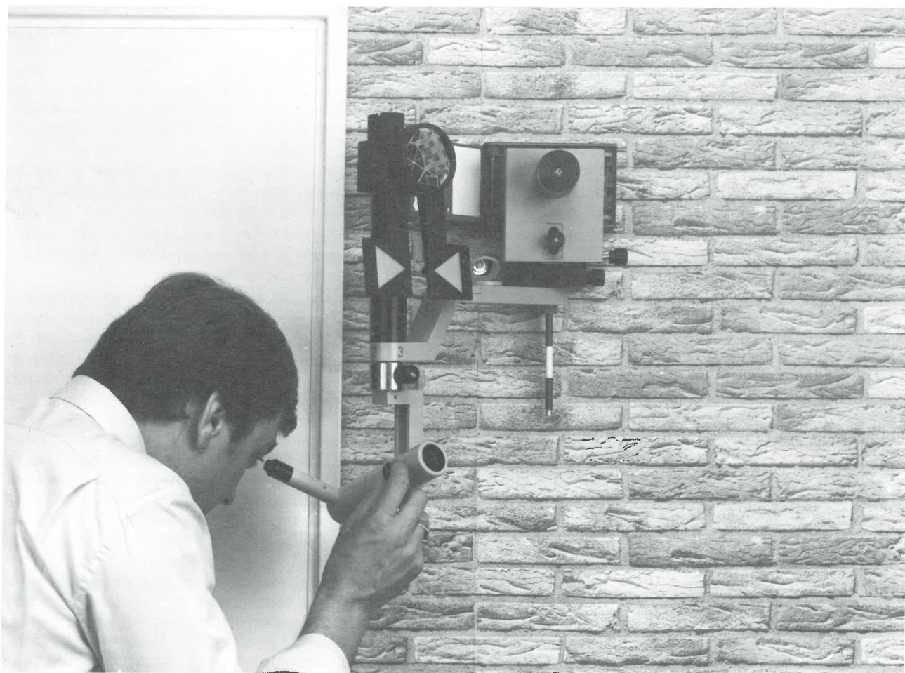
Opérateur effectuant l'orientation du prisme
