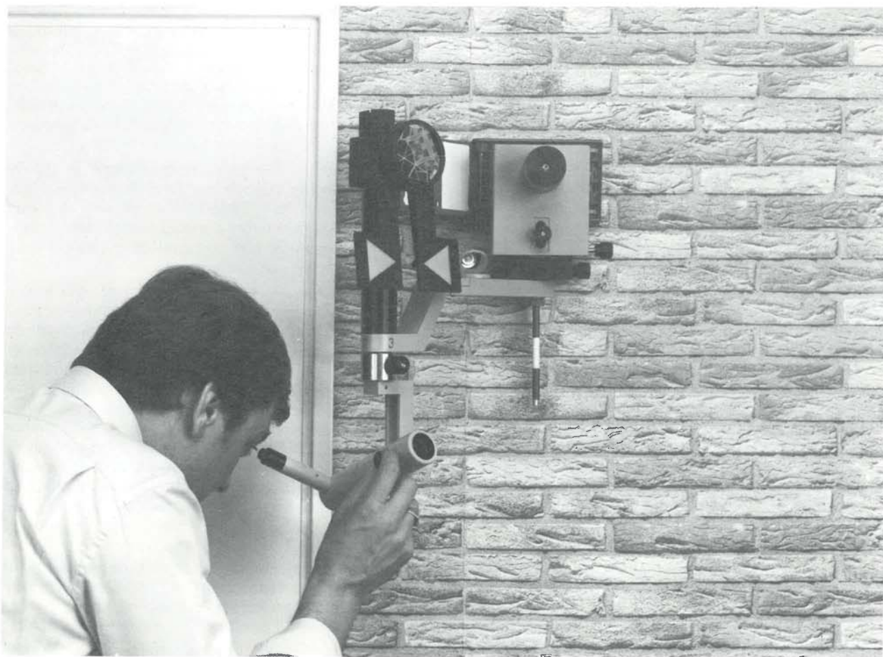
Opérateur effectuant l'orientation du prisme
