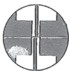
Fig. 3 - Aspect des 2 moitiés du champ du viseur à visées orthogonales simultanées
