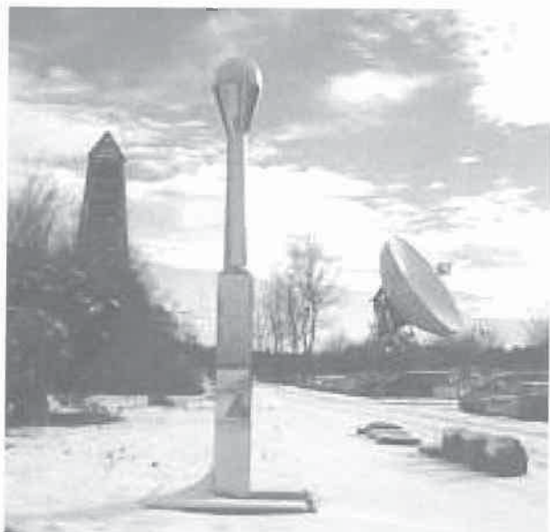
Fig. 2 - Récepteur GPS permanent monté sur un mât de 5 m (au premier plan) et antenne VLBI (en arrière plan), site de Tsukuba, région de Tokyo, Japon.
