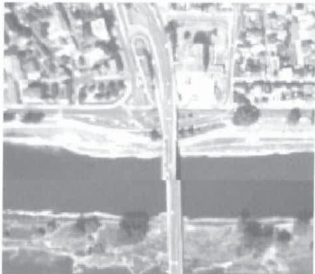
Fig. 3 - Décalage géométrique entre deux ortho-images contiguës
