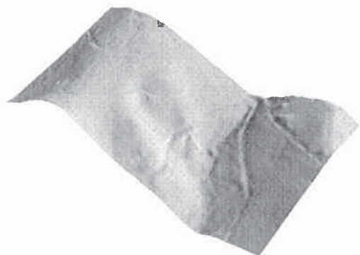
Figure 12. Résultat de l'interpolation après filtrage des données Toposys (65 806 points)
