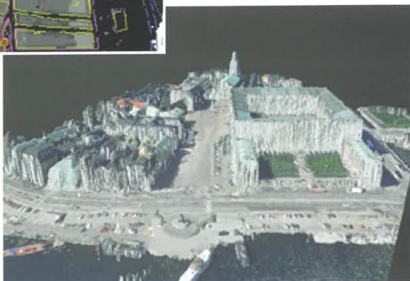
Fig. 5 : Les données du scanner laser sont associées aux données 2D cartographiques à gauche, et drapées d'une image aérienne en bas à droite.
