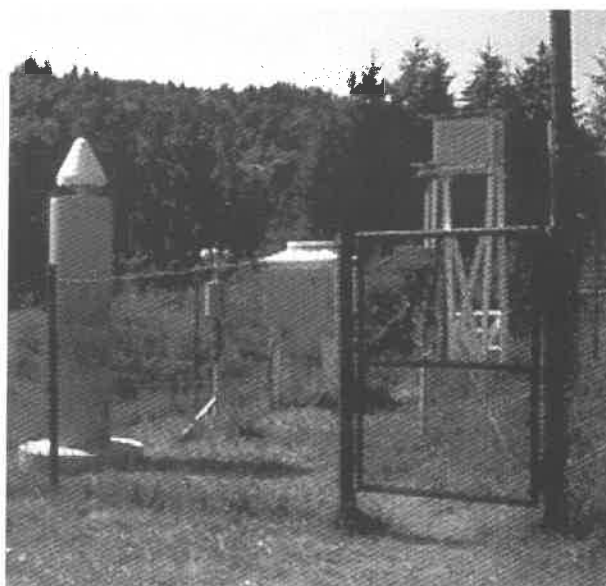
Fig. 4 – Installation GPS permanente à La Feclaz, Savoie.
